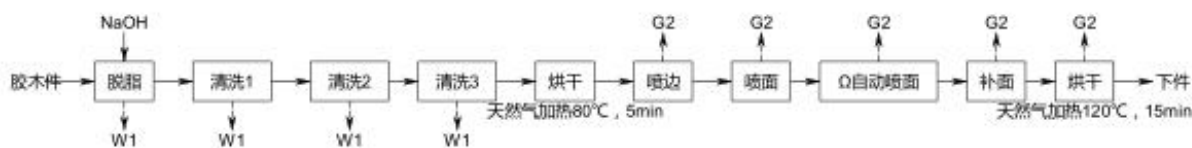
图 2.2-7 胶木件脱脂清洗、喷漆工艺流程图（塑料件喷漆前道不需要脱脂工艺、Ω自动喷面工艺）
